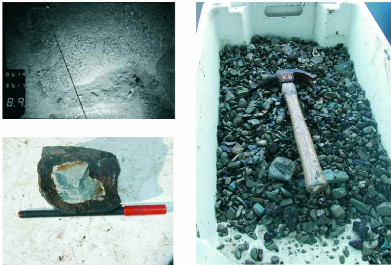
Figura 10. (Izquierda) Fotografía submarina tomada con una cámara Benthos a unos 1100 metros de profundidad, en la que se observa un campo de nódulos descubierto en el Golfo de Cádiz y relacionado con la zona de expulsión de fluidos. (Centro) Muestra de nódulos extraída en el lugar donde se ha tomado la foto. Los nódulos se muestrearon con una draga de arrastre bentónico a bordo del B/O Cornide de Saavedra en el año 2001. (Derecha) Detalle de un nódulo polimetálico partido por la mitad en el que se aprecia el núcleo constituido por las margas azules del Mioceno y recubierto por sucesivas capas de metales (Díaz del Río, 2001).
