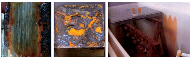
Figura 12. Ensayo de envejecimiento de material híbrido en cámara de niebla salina
