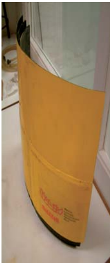
Figura 1. "Panel curvo compuesto fabricado con Malecon®"
