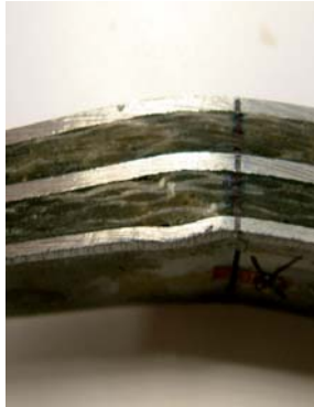
Figura 5. "Fallo por pandeo local de un laminado híbrido fibra-metal"
