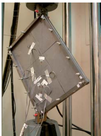
Figura 11. Ensayo de paneles ensamblados a flexión y ensayo de paneles ensamblados a tracción-compresión en un bastidor con los dispositivos de medida extensiométricos
