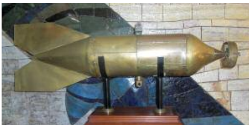
Figura 6. Batitermógrafo empleado en los primeros tiempos del Laboratorio Oceanográfico (construido hacia 1925) y actualmente expuesto en el Centro Oceanográfico de Málaga.
